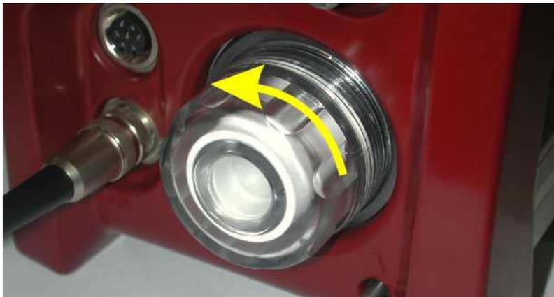
Извлеките корпус фильтра и замените фильтрующий элемент. Не забудьте уплотнительное кольцо.
