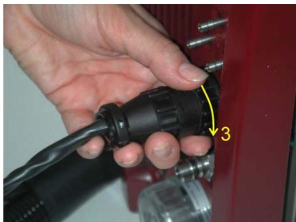
Подсоедините быстросъемный разъем газового шланга к газовому входу анализатора, потянув на себя кольцо на разъеме (4) и отпустите кольцо после установки (5).
