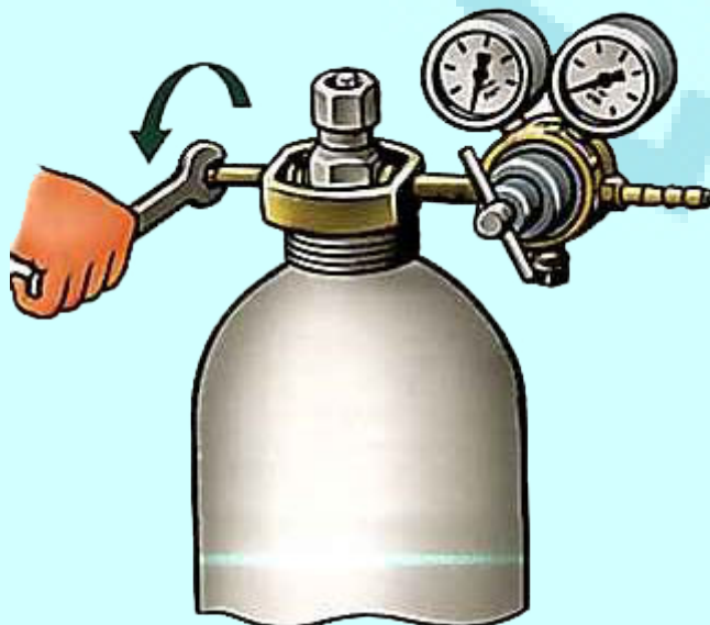
Рис. 6. Подсоединение ацетиленового редуктора
