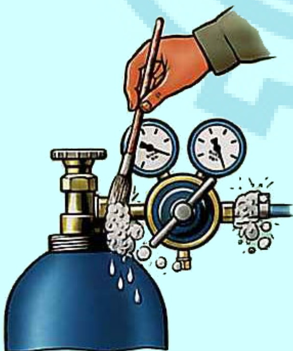
Рис. 15. Проверка утечки газа;
