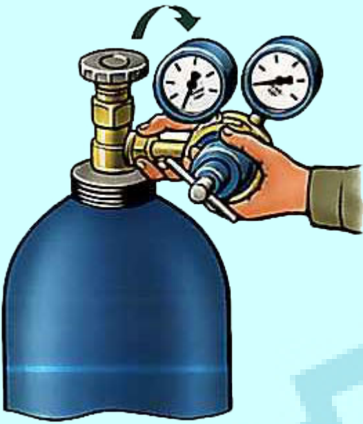
Рис. 4. Присоединение накидной гайки.
