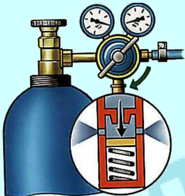
Рис. 13. Проверка предохранительного клапана;
