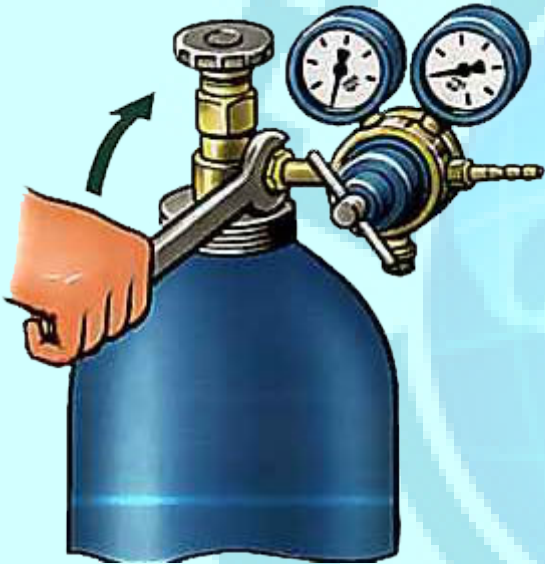
Рис. 5. Затягивание гайки ключом.
