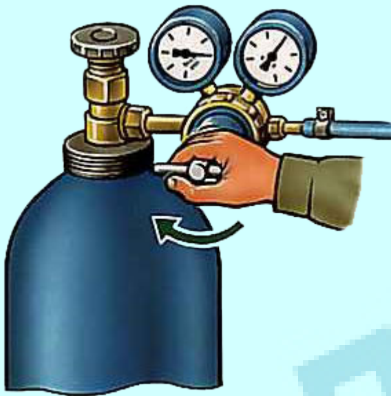
Рис. 10. Установка рабочего давления.
